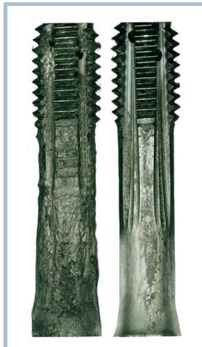
5 Links ein Gewindefurcher mit herkömmlicher Nut, bei dem das Gewindeteil und die Nut durch Partikel zugesetzt sind; rechts das Bass-Tools-Werkzeug mit patentierter Fächernut, das trotz längerer Gebrauchsdauer in besserem Zustand ist © Bass
